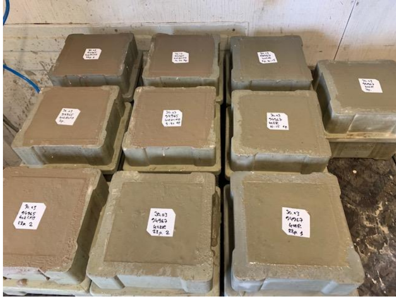
Foto 4 Betoonitehase laboris katsete käigus vormitud katsekehad
