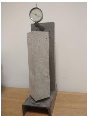
Foto 9 Katseseade mõõtekella ja katsekehaga
