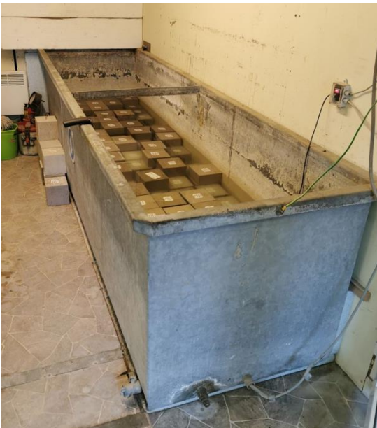
Foto 5 Tänaõhku laboris katsekehade hoiustamise veevann
