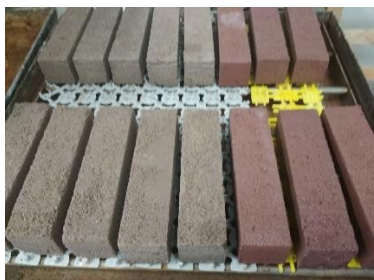
Foto 1 Tuhkmördist katsekehad vesivannil. Kivistamine kaanega kaetult.
