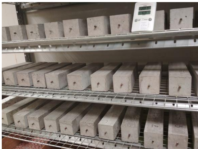
Foto 10 Katsesekad on asetatud kivinema kliimaruumis (23±2)°C ja (50±5)% RH
